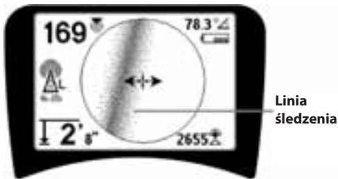
Rysunek 20: Linia śledzenia przedstawia duże zniekształcenie
