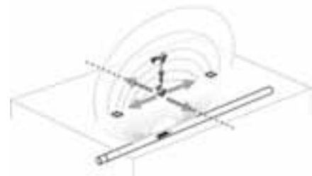
Abbildung 27: Pole und Äquator einer Sonde
