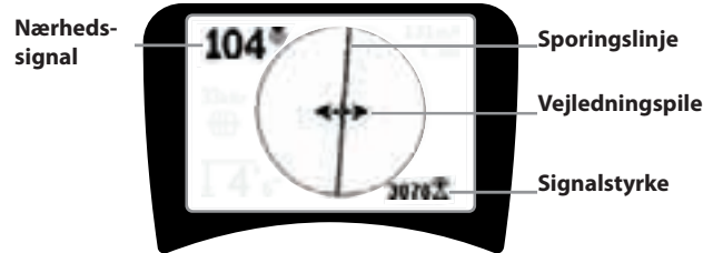
Fig. 5: Displayelementer (funktionstilstand ledningssporing)
