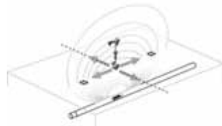
Figura 27: Pólos e Equador de uma Sonda
