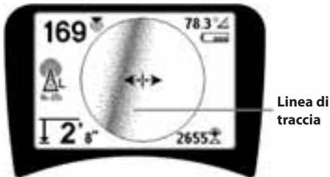
Figura 20: Linea di traccia che mostra un'alta distorsione
