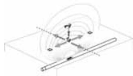
Figur 27: Poler og ekvator til en sonde
