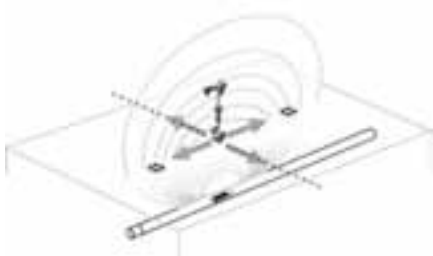
Figuur 27: polen en 0-lijn van een sonde
