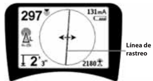
Figura 19: Línea de rastreo indicando baja distorsión
