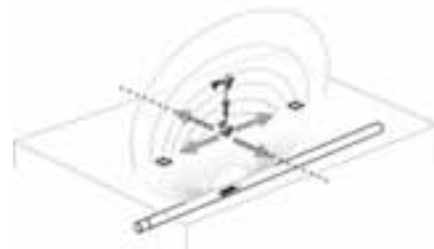
Figura 27: Poli ed equatore di una sonda
