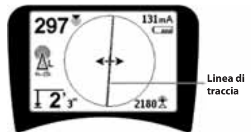
Figura 19: Linea di traccia che mostra una bassa distorsione
