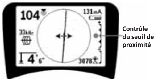
Figure 33: Contrôle du seuil de proximité
