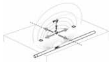
Figura 27: Polos y ecuador de una sonda.
