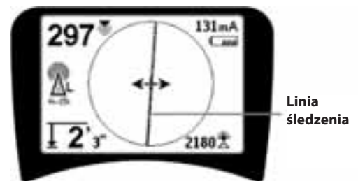
Rysunek 19: Linia śledzenia przedstawia niewielkie zniekształcenie
