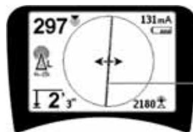
Abbildung 19: Suchlinie bei geringer Verzerrung
