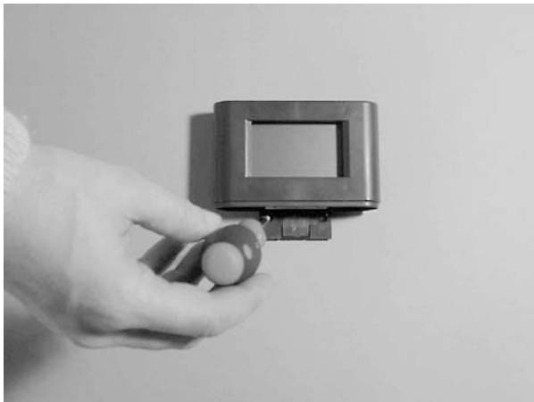
Bild: Befestigen eines Datenloggers
